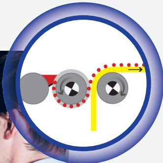
Beschichtung von Textilien mit Schmelzklebstoffen. Eine Vielzahl von Auftragsrastern und glatte Filme können aufgetragen werden. Kaschierungen sind möglich. Die Thermoplasten schmelzen ab 60 °C. Hotmelts mit Schmelzpunkten bis zu 160 °C können appliziert werden; Warenbreiten bis 2,10 m. Basis der Schmelzklebstoffe: CoPA, CoPES, EVA, PO, TPU.
