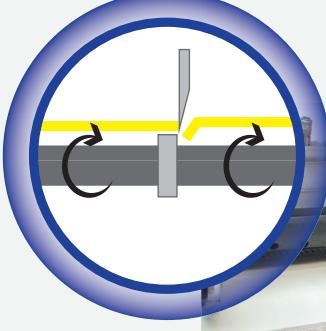
Konfektion von beschichteten und kaschierten Artikeln auf gewünschte Rollengrößen; beinhaltet auch Warenbeschau. Fehler werden ausgesondert oder markiert. Optional führen wir einen Kantenschnitt durch. Beim Aufrollen können PE- oder Silikonpapierträger in die Ware miteinlaufen. Mit der Schneideanlage können wir die Textilien auf gewünschte Bandbreiten zuschneiden.
