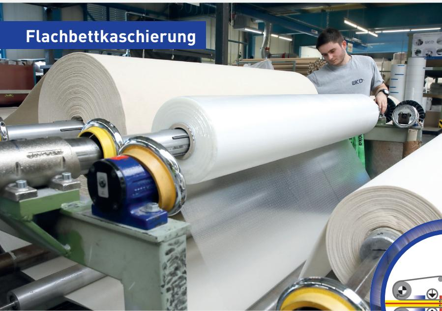
Zu kaschierende Materialien werden über das Flachbettverfahren mittels Schmelzklebewebs bzw. -filmen miteinander verbunden. Bei gleichmäßig verteilten Druck- und Temperaturverhältnissen können hochwertige Kaschierungen realisiert werden. Warenbreiten von 1 m bis 1,60 m; Minderbreiten auf Anfrage. Basis der Klebeweb /-filme: modifizierte EVA, CoPES, CoPA, TPU.
