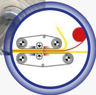
Das thermoplastische Schmelzklebepulver wird gleichmäßig aufgestreut und mit Druck und Temperatur auf der Oberfläche fixiert. Auch temperaturempfindliche Materialien können auf diese Art schonend beschichtet werden; Kaschierungen sind möglich; Warenbreiten von 1,20 bis max. 1,70 m. Basis der Schmelzklebstoffe: CoPA, CoPES, EVA, TPU, PE.
